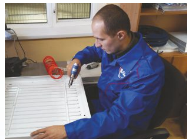
МОНТАЖ СВЕТИЛЬНИКОВ
