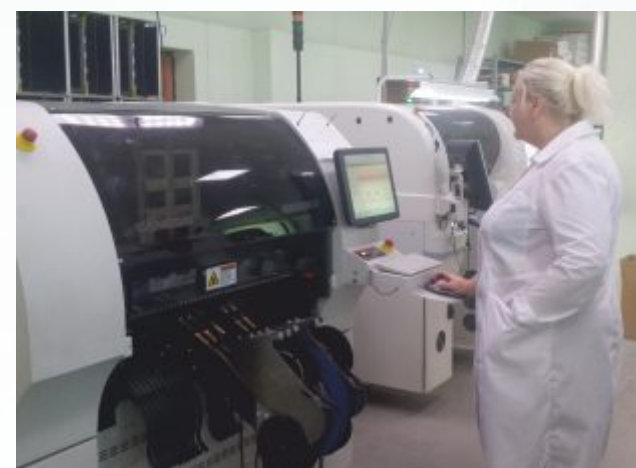
МОНТАЖ СВЕТОДИОДОВ НА ПЕЧАТНЫЕ ПЛАТЫ
