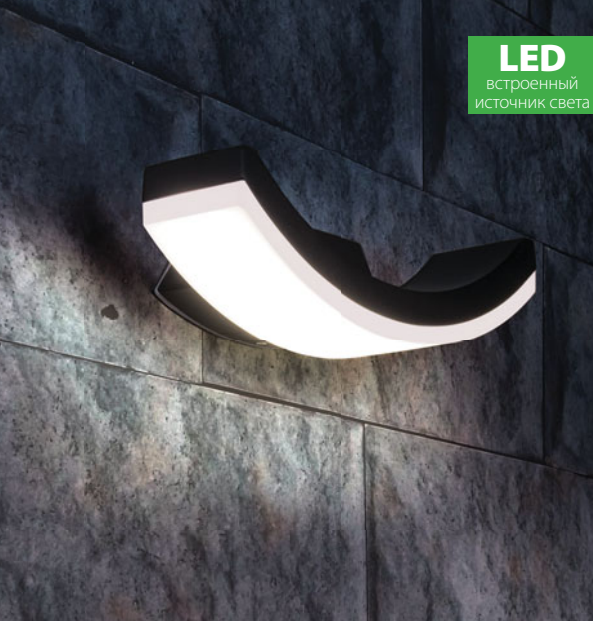
1672 TECHNO LED Asteria U 6 Вт 320 лм 4200K 275 × 112 × 82 мм IP54
