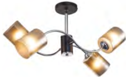
661/4PL Светильник на штанге ⌀ 4 × E27 60Вт Арматура: металл ● черный Плафон: стекло ● хром ↔ 630 ↗ 250 ↕ 290
