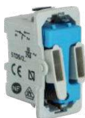
FD16599 Push-button with temporized switch and diffuser. Timing 3 min. Max 500W incandescent 230V~ Bouton-poussoir avec interrupteur et diffuseur temporisé. Synchronisation 3 min. Max 500Wà incandescence 230V~ Pulsante con interruttore temporalizzato e diffusore. Tempo minimo 3min. Max 500W incandescente 230 V~ Pulsador con interruptor temporizador y difusor. Tiempo 3 min. Max 500W incandescente 230V~ Taster mit zeitlich einstellbaren Schalter und Diffusor 3 min. Max 500W Glühlampe 230V
