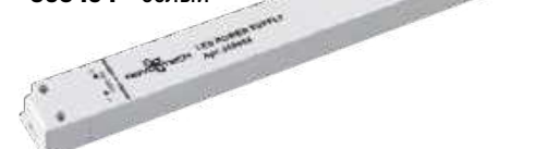
IP 20 Драйвер Пластиковый корпус Выходная мощность: 240 Вт Выходное напряжение: 48 В Входное напряжение: 200–240 В (Д*Ш*В) 356,4*32*22,3 мм
