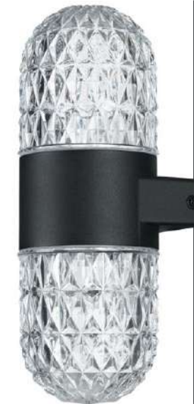
359296 IP 65 Светильник ландшафтный настенный светодиодный Алюминий/стекло 14 Вт 175 – 265 В 1232 Лм 4000 К Цвет LED белый Диапазон раб. тем-р от -25° до +45° С Угол рассеивания 115°
