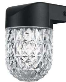
359295 IP 65 Светильник ландшафтный настенный светодиодный Алюминий/поликарбонат 7 Вт 175 – 265 В 616 Лм 4000 К Цвет LED белый Диапазон раб. тем-р от -25° до +45° С Угол рассеивания 106°
