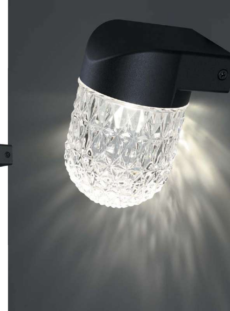
359296 IP 65 Светильник ландшафтный настенный светодиодный Алюминий/стекло 14 Вт 175 – 265 В 1232 Лм 4000 К Цвет LED белый Диапазон раб. тем-р от -25° до +45° С Угол рассеивания 115°
