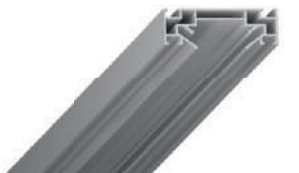
ST038.129.02 ■ алюминий анодированный световая линия под натяжной ПВХ потолок L2000 × W82 × H29 MM
