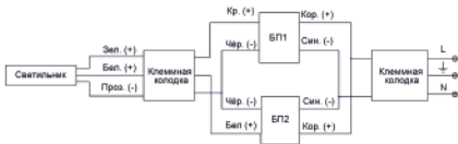
Рис. 3. Схема монтажных соединений. (Рисунок 3А для ДД=310 мм, Рисунок 3Б для ДД=600 мм.)
