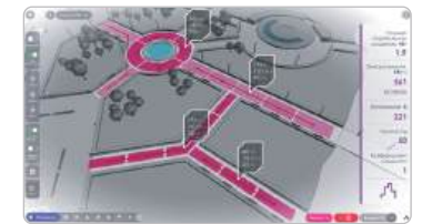
Цифровой учет энергопотребления каждого светильника
