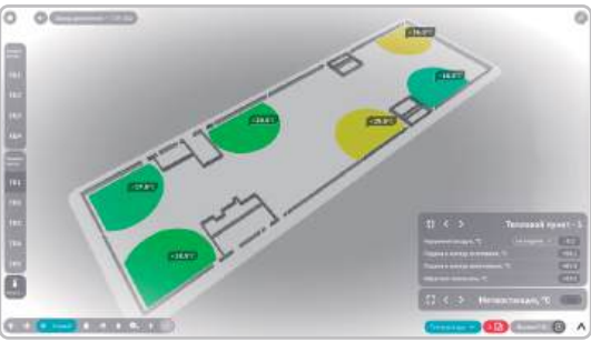
Тепловая карта и показания датчиков температуры
