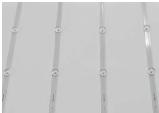
линзы внутри корпуса светильника
