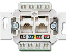
EPUAЕ8-8UPOK6US Компьютерная розетка с LSA-Plus для подключения проводов; категория 6, 8 полюсов, 2 терминала, неэкранированная
