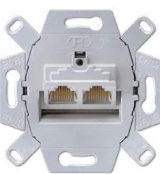
EPUAЕ8-8UPOK6 Компьютерная розетка с LSA-Plus подключением проводов; категория 6, 8 полюсов, 2 терминала, полностью экранированная
