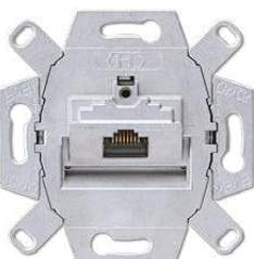
EPUAЕ8UPOK6 Компьютерная розетка с LSA-Plus подключением проводов; категория 6, 8 полюсов, 1 терминал, полностью экранированная
