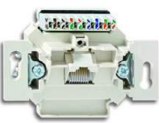
EPUAЕ8UPOK6US Компьютерная розетка с LSA-Plus для подключения проводов; категория 6, 8 полюсов, 1 терминал, неэкранированная.
