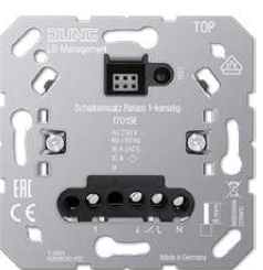
1701SE Релейная вставка 1-канальная ~ 230 V, 50Hz, для датчика движения A1180, A1180WW, A1180AL, DAW360WW, DAW360AL, PMU360WW, PMU360AL, необходим нейтральный проводник
